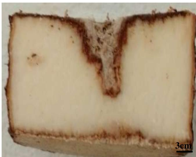
Fig 3:- Hauteur de pourriture de rondelle inoculée avant traitement.
